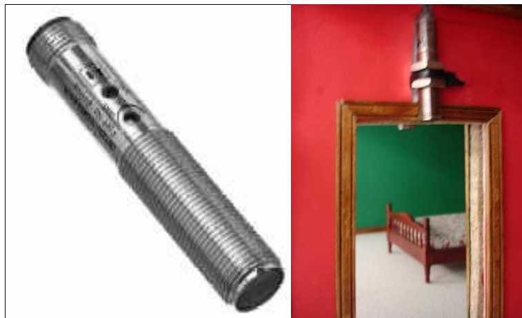
Figura 5: Sensor fotoeléctrico utilizado (izquierda) y colocación a la entrada del dormitorio (derecha)
