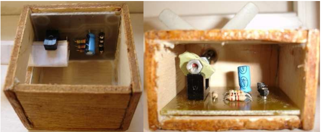
Figura 3: Circuito diseñado con optoacoplador detectando cartas en el buzón (arriba) y detectando la posición de la hélice del sensor de viento (abajo)
